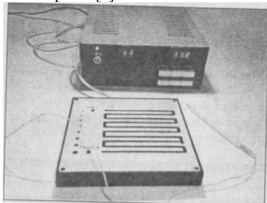
Рис. 13. Прибор для измерения состояния мышечной системы человека при стрессе (тремометр)
