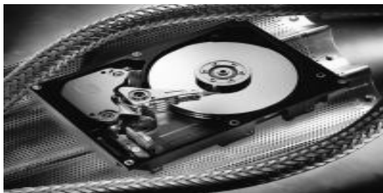
Рис. 11.1 Вигляд внутрішньої порожнини корпусу вінчестера
