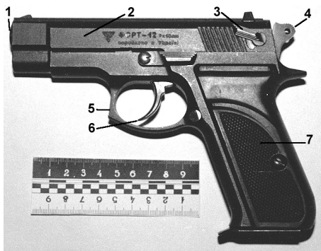
Рис. 10. Пістолет «Форт» (виробляється в Україні): 1 — дульний зріз; 2 — кожух; 3 — запобіжник; 4 — курок; 5 — спускова скоба; 6 — спусковий гачок; 7 — рукоятка
