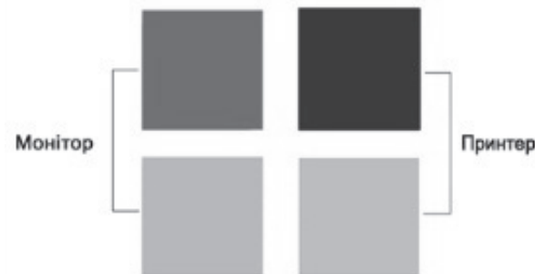
Рис. 1.26. Невідповідність кольорів, які відображаються на екрані монітора, з друківаними на принтері
