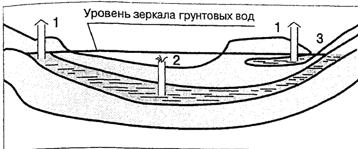
Рис. 31. Простой (1), артезианский (2) колодцы и источник (3)
