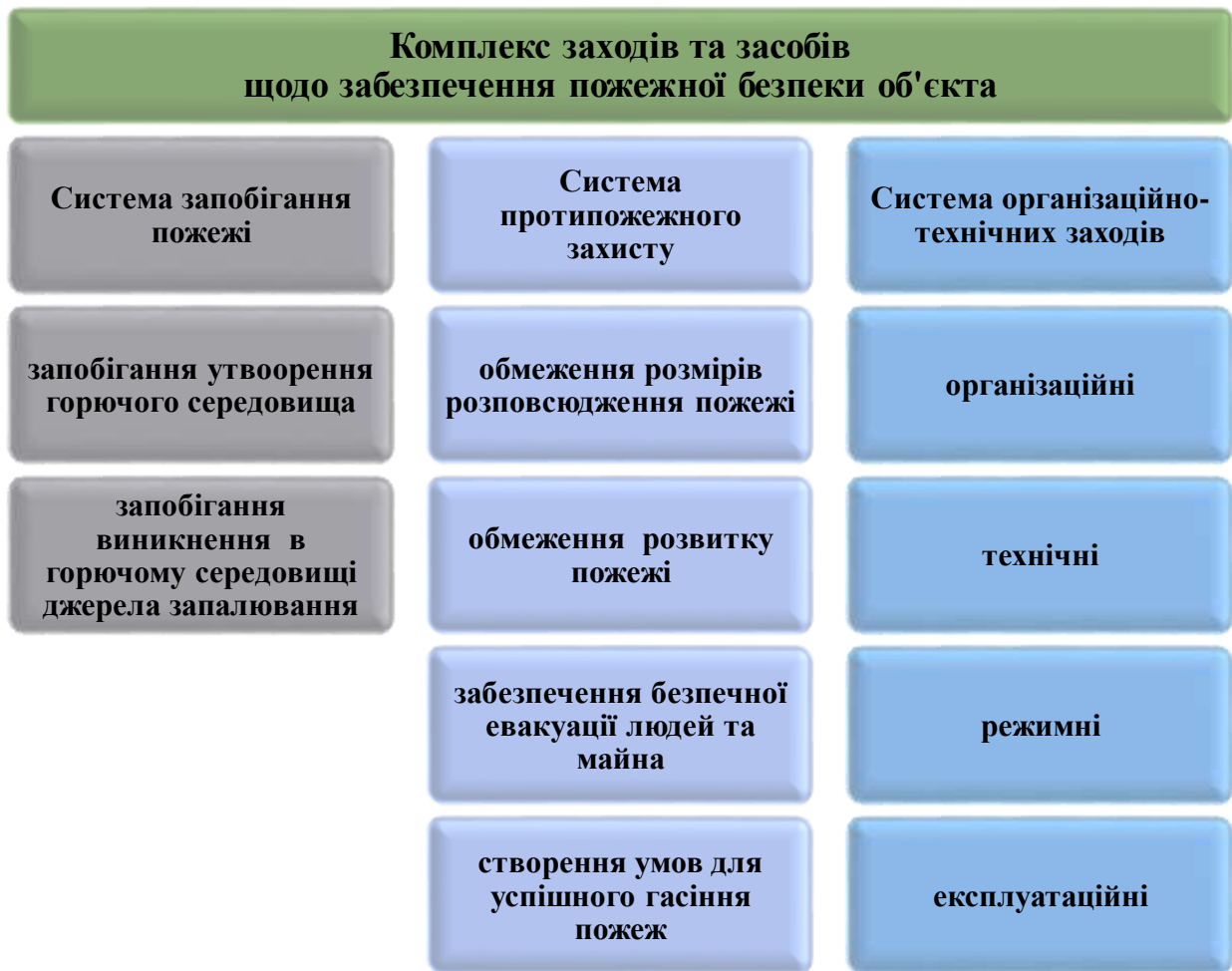
Рис. 13.1. Загальна схема комплексу заходів та засобів щодо забезпечення пожежної безпеки об'єкта
