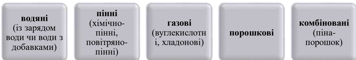
Рис. 13.8. Види вогнегасників залежно від вогнегасної речовини
